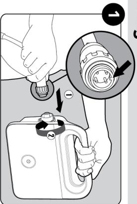
Das Schwimmkabel mit dem Stromversorgungsgerät verbinden
