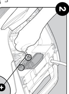
Mithilfe eines kurzen Schraubenziehers die beiden Schrauben lösen.
