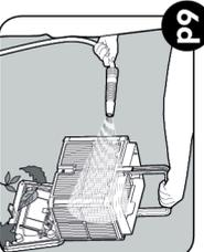
Den Filterkorb mit einem Schlauch reinigen.
