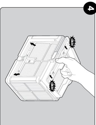
Die Filterplatten wieder einsetzen.
