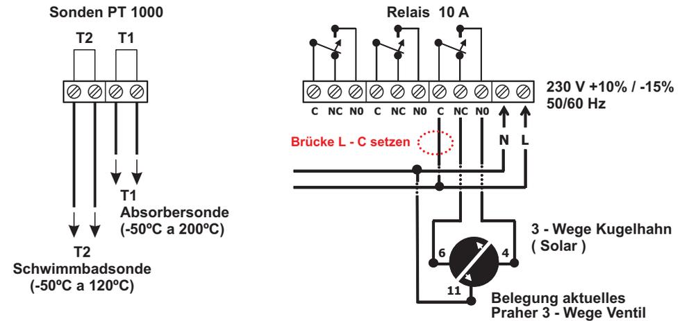
Anschlüsse OKU Suncontrol mit separater Pumpe und Schaltschütz
