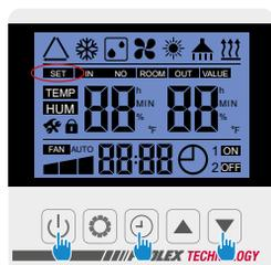
Druk tegelijkertijd gedurende 3 seconden op + + knippert snel, de schakelkast is klaar om te worden gekoppeld.
