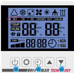
Appuyez sur + + simultanément pendant 3s, le voyant **SE** clignote rapidement, le boîtier de commande est prêt à être appairé.
