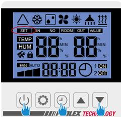
Drücken Sie + + drei Sekunden lang gleichzeitig, die Kontrollleuchte **SET** blinkt schnell, die Steuereinheit ist bereit für die Kopplung.
