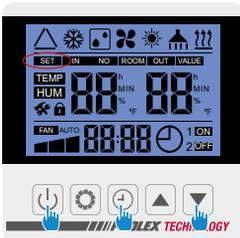
Haga clic en + + simultáneamente durante 3s. El pilotot **SET** parpadea rápidamente, la caja de mandos está lista para sincronizar.
